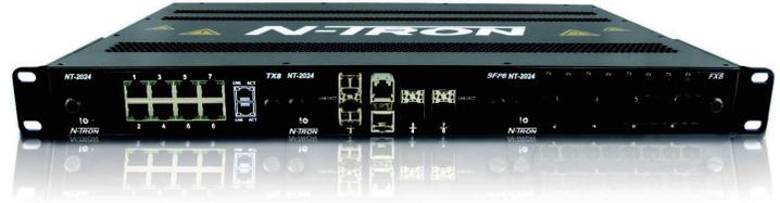
N-Tron<sup>®</sup> NT2024多功能管理型工业级以太网交换机配备多达 24 个千兆端口和广泛的连接选择（包括 100Base、千兆、光纤和网线选项）并封装在坚固的 1U 19"型机箱中。NT2024 交换机能够应对最苛刻的环境，支持线速吞吐率转发和双电源输入，增强的抗冲击与振动能力，可抵御极端工作温度变化，同时还提供有三个插槽供混用端口模块使用。N-Ring<sup>™</sup> 技术能够在至多 30 ms 内完成故障检测并恢复网络通信。该系列交换机拥有强大的远程控制功能，让网络管理从此变得简单。
